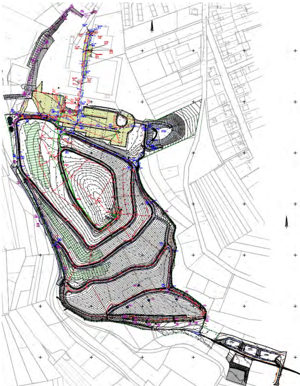
Abbildung 49 Bestandsplan (gesamt) ehemalige Hausmüll-Deponie Ohmbach nach Sanierung und Rekultivierung (Quelle: Hermanns HTI-Bau)
