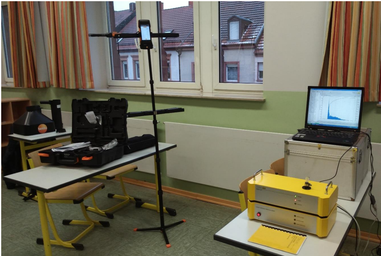
Abb. 2 Messaufbau zur Erfassung Klimaparameter (links) und Partikelmessung (rechts)
