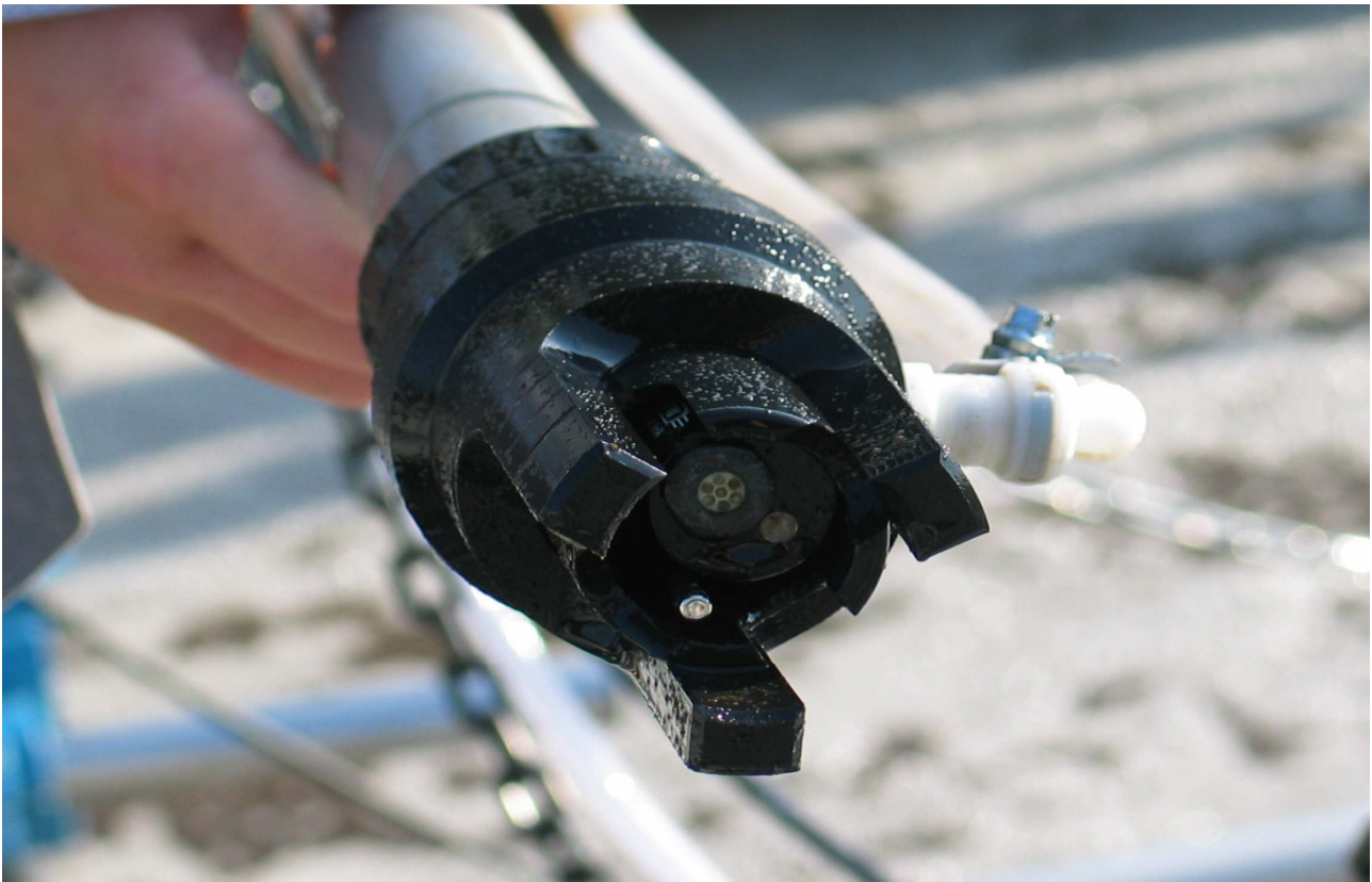
Abb. 3: Beispiel Messinstrumentierung Ionenselektive Sonde für Ammonium (AmmoLyt - WTW)
