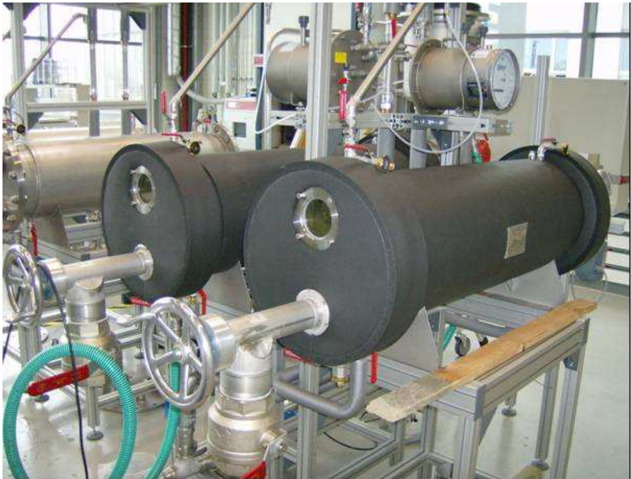
Abb. 4: Parallelansatz für dynamische Gärtests im Technikum des PFI
