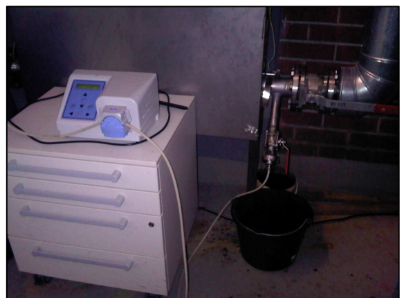
Abb. 12 Versuche zum TDH-Natronlaugeaufschluss an der Kläranlage Blümeltal
